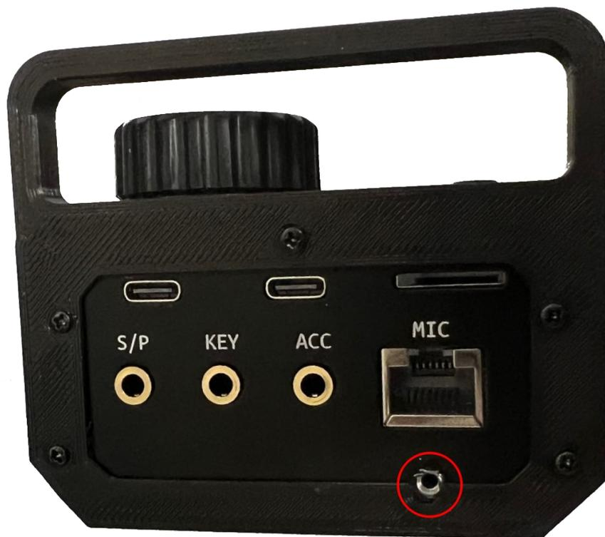
Verwenden Sie die zuvor entfernten Gehäuseschrauben um die Haltegriffe anzuschrauben.
