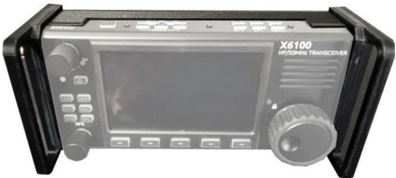
Lösen Sie die Inbusschraube der Standfüsse und entfernen Sie die Standfüsse.
